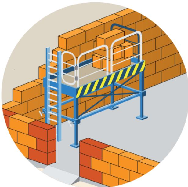
*Fig. 8-a : Plate-forme à hauteur fixe*
